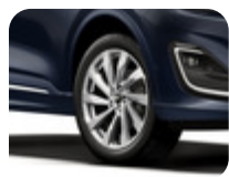
Alufælg 19" 10-eget design, Luster Nickel 7,5 x 19", indpresningsdybde 50, til dækstørrelse 225/55 R19
