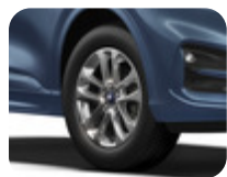
Alufælg 17" 5 x 2-eget design, Shadow Silver 7 x 17", indpresning 50, til dækstørrelse 225/65 R17
