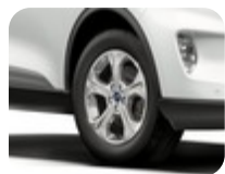
Alufælg 17" 5-eget design, Shadow Silver 7 x 17", indpresningsdybde 50, til dækstørrelse 225/65 R17
