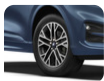
Alufælg 18" 5 x 2-eget Y-design, Glass Magnetic 7,5 x 18", indpresning 50, til dækstørrelse 225/60 R18
