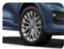
Alufælg 19" 15-eget design, Luster Nickel 7,5 x 19", indpresning 50, til dækstørrelse 225/55 R19
