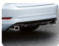
Bagkofanger, vindaflæder nederst blank sort til modeller med parkeringshjælp og 2 afgangsrør
