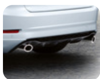
Bagkofanger, vindaflæder nederst blank sort til modeller uden parkeringshjælp og med 2 afgangsrør
