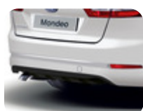
Bagkofanger, vindaflæder nederst sort Til modeller med 2 afgangsrør og parkeringshjælp
