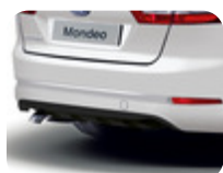
Bagkofanger, vindaflæder nederst sort Til modeller med 1 afgangsrør og parkeringshjælp
