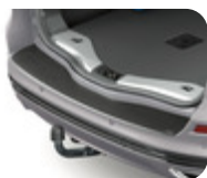
ClimAir®* Læssekantbeskytter til bagkofanger formet, Matte Black Beskytter bagkofangeren ved på- og aflæsning, fremstillet af slidstærkt materiale – Stationcar
