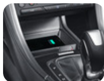
ACV Trådløst Qi-opladningssæt indbygget, modelspecifik løsning Models specifikt plug&play-system til nem og hurtig trådløs opladning af Qi-kompatible smartphones (induktiv opladningsteknologi). Går i gang med at oplade, så snart smartphonen lægges på opladerpladen inden for opladefeltet, og opladeren skifter automatisk til standby, når batteriet er helt opladet. Som ekstra sikkerhed slår opladeren fra automatisk, hvis mønter eller andet metal kommer i kontakt med opladerpladen. Modelspecifik opladerplade med skridsikker overflade samt optisk fiberledning medfølger
