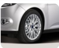
**Llantas de aleación 17" diseño de 10 x 2 radios en Y, en color plata.**
