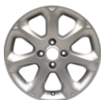
Llantas de aleación 16" diseño de 7 radios, en color plata. 6,5 x 16", ET 41,5, para neumáticos 195/45 R16.
