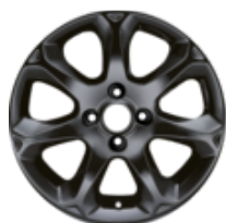
Llantas de aleación 16" diseño de 7 radios, en color negro pantera. 6,5 x 16", ET 41,5, para neumáticos 195/45 R16.
