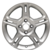
Llantas de aleación 16" diseño de 5 x 2 radios, en color plata. 6,5 x 16", ET 41,5, para neumáticos 195/45 R16.
