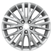
Llantas de aleación 17" diseño premium de 10 radios, en color plata. 7 x 17", ET 50, para neumáticos 215/50 R17. – Excepto ECONetic.
