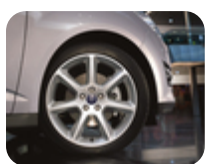
Llantas de aleación 18" diseño de 7 radios, en color plata. 8 x 18", ET 55, para neumáticos 235/40 R18, solo en combinación con limitador de cremallera de la dirección. – Excepto ECONetic.
