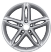
Llantas de aleación 17" diseño premium de 5 radios, en color plata. 7 x 17", ET 50, para neumáticos 215/50 R17. – Excepto ECONetic.
