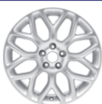
Llantas de aleación 18" diseño de 8 radios en Y, en color plata Sterling. 8 x 18", ET 55, para neumáticos 235/40 R18, solo en combinación con el limitador de cremallera de la dirección. – Excepto ECONetic.
