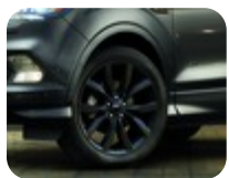
Llantas de aleación 19" diseño de 5 x 2 radios, en color negro absoluto. 8 x 19", ET 52,5, para neumáticos 235/45 R19.
