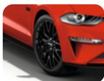
**Llantas de aleación 19" delanteras, diseño de 10 radios en Y, en color negro.**
