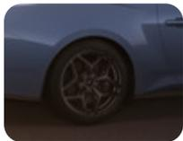
**Llantas de aleación 19" traseras, diseño de 5 radios, en color negro mecanizado barnizado**
