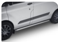
ARP* Protecciones laterales diseño tubular de acero inoxidable pulido con esquinas curvas.
