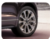
Kevytmallivanteet 20" 10-puolainen malli, kiillotettu alumiini 8,5 x 20", ET 52,5, renkailla 255/45 R20 – Vignale
