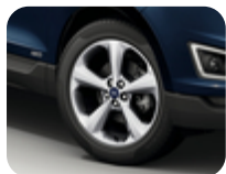
Kevytmallivanteet 18" 5-puolainen malli, kiiltävä hopea 7.5 x 18", ET 55, renkailla 235/50 R18 ja 235/60 R18 – Ei Vignale-malleihin
