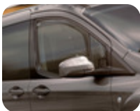
ClimAir®* Sivuikkunan tuulenohjain etuikkunoihin, läpinäkyvä 2 kpl:n sarja, parantaa ilmanvaihtoa sekä suojaa lumelta ja sateelta. 3 mm paksua valettua akryyliä. Huolehdi, että (peilialueen) tuulenohjain on asetettu oikein (kiskolle), eikä se liu'u ikkunarakoon. TÜV testattu ABE:n kanssa.
