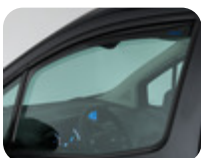
ClimAir®* Sivuikkunan tuulenohjain etuikkunoihin, musta 2 kpl:n sarja, parantaa ilmanvaihtoa sekä suojaa lumelta ja sateelta, 3 mm paksua valettua akryyliä. Huolehdi, että (peilialueen) tuulenohjain on asetettu ikkunalaudalle (kiskolle), eikä se liu'u ikkunarakoon. TÜV testattu ABE:n kanssa.
