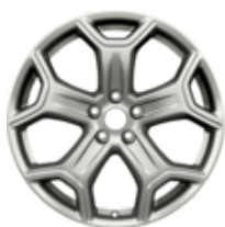
Jante en alliage 19" Modèle à 5 branches, Luster Nickel 8 x 19", déport 52,5, pour pneus 235/45 R19
