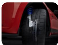
**Kit de suspension avec ressorts hélicoïdaux sur amortisseurs acier inoxydable avec ressorts laqués en bleu Ford Performance**
