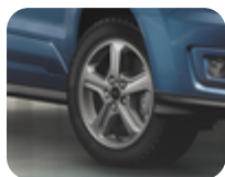
Jante en alliage 16" modèle 5 x 2 branches, Dark Stainless 6,5 x 16", déport 50, pour pneus 205/60 R16 et 215/55 R16
