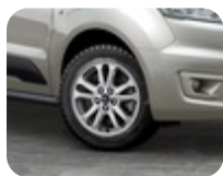
Jante en alliage 16" modèle 5 x 2 branches, argent brillant 6,5 x 16", déport 50, pour pneus 205/60 R16 et 215/55 R16
