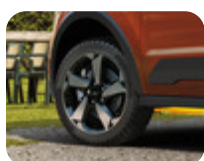
Jante en alliage 17" Modèle à 5 branches, noir usiné 6.5 x 17", déport 50, pour pneus 215/55 R17
