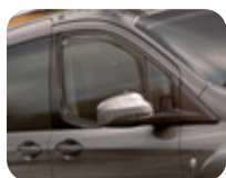
Déflecteurs d'air pour vitres avant, transparent ClimAir®* Jeu de 2, réduit les turbulences et le bruit et permet de circuler confortablement avec les vitres baissées, verre acrylique coulé 3 mm. Veillez à ce que le déflecteur d'air (dans la zone du rétroviseur) repose sur le rebord de la vitre (glissière) et ne glisse pas dans la fente de la vitre.
