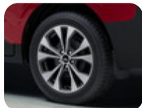
**Jante en alliage 17" modèle à 5 x 2 branches, Magnetic Machined**
