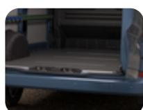
**Plancher de chargement en bois avec rails Airline intégrés**
