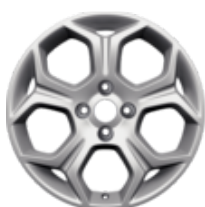
Ζάντα ελαφρού κράματος 17" 5 ακτίνων σε σχήμα αστέρα, ασημί 6.5 x 17", offset 40, για ελαστικά 205/45R17 – μόνο σε συνδυασμό με αναστολείς κρεμαγιέρας
