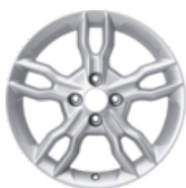
Ζάντα ελαφρού κράματος 16" 5 x 2 ακτίνων, σε χρώμα Sparkle Silver (ασημί) 6.5 x 16, offset 40, για ελαστικά 195/55R16
