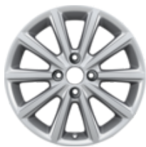
Ζάντα ελαφρού κράματος 16" 10 ακτίνων, ασημί 6.5 x 16", offset 40 mm, για ελαστικά 195/55 R16
