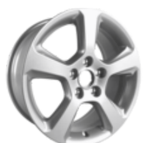
Ζάντα ελαφρού κράματος 16" 5 ακτίνων, ασημί 7 x 16", offset 50 mm, για ελαστικά 205/55 R16 και 215/55 R16 – Grand C-MAX με κινητήρα βενζίνης Ti-VCT για ελαστικά 205/55 R16 μόνο
