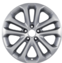
Ζάντα ελαφρού κράματος 17" 5 x 2 ακτίνων, ασημί 7 x 17", offset 50 mm, για ελαστικά 215/50 R17
