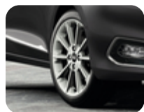
Ζάντα ελαφρού κράματος 17" 10 ακτίνων, σε χρώμα Luster Nickel 7 x 17", offset 47,5 mm, για ελαστικά 205/45 R17
