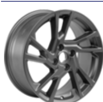
Ζάντα ελαφρού κράματος 17" 5 x 2 ακτίνων, με φινίρισμα Magnetite/φρεζαριστό μεταλλικό 7 x 17", offset 42,5 mm, για ελαστικά 205/45 R17. – ST
