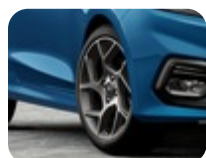
Ζάντα ελαφρού κράματος 17" 5 x 2 ακτίνων σε σχήμα αστέρα, με γκρι φινίρισμα Flash Grey 7,5 x 17", offset 42,5 mm, για ελαστικά 205/45 R17. – ST
