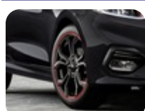
Ζάντα ελαφρού κράματος 17" 5 x 2 ακτίνων σε σχήμα αστέρα, σε μαύρο χρώμα με κόκκινο περιμετρικό δακτύλιο 7 x 17", offset 47,5 mm, για ελαστικά 205/45 R17. – Εκτός ST και Active.
