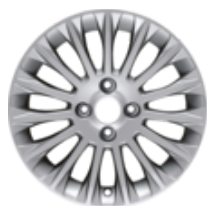
Ζάντα ελαφρού κράματος 16" 15 ακτίνων, ασημί 6.5 x 16", offset 41,5 mm, για ελαστικά 195/45 R16
