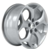
Ζάντα ελαφρού κράματος 16" 5 ακτίνων σε σχήμα Y, ασημί 7 x 16", offset 50 mm, για ελαστικά 205/55 R16 και 215/55 R16
