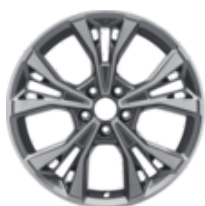
Ζάντα ελαφρού κράματος 18" 5 x 2 ακτίνων, με φρεζαριστό φινιρίσμα Dark Tarnish 8 x 18", offset 55 mm, για ελαστικά 235/45 R18 – Εκτός EConetic, BEV και RS, μόνο σε συνδυασμό με αναστολές κρεμαγιέρας
