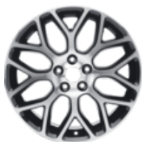
Ζάντα ελαφρού κράματος 18" 8 ακτίνων σε σχήμα αστέρα, σε μαύρο χρώμα, σαγρέ 8 x 18", offset 55 mm, για ελαστικά 235/40 R18
