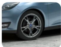
Ζάντα ελαφρού κράματος 18" 5 x 2 ακτίνων σε σχήμα Y, Rock Metallic 8 x 18", offset 55 mm, για ελαστικά 235/40 R18, μόνο σε συνδυασμό με αναστολές κρεμαγιέρας – Εκτός EConetic, BEV και RS
