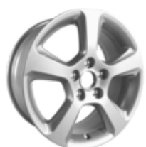
Ζάντα ελαφρού κράματος 16" 5 ακτίνων, ασημί 7 x 16", offset 50 mm, για ελαστικά 205/55 R16 και 215/55 R16 – Εκτός του EConetic
