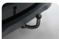
Μόνο σε συνδυασμό με κιτ ηλεκτρικής σύνδεσης ειδικό για κάθε μοντέλο, κατάλληλος για βάση έως 2 ποδηλάτων. Επιτρέπει ενεργοποίηση του συστήματος ελέγχου αναδίπλωσης ρυμουλκούμενου (TSC) μέσω του βασικού ηλεκτρονικού συστήματος ελέγχου ευστάθειας
