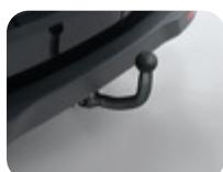
Μόνο σε συνδυασμό με ειδικό κιτ ηλεκτρικής σύνδεσης για κάθε αυτοκίνητο, κατάλληλος για βάσεις έως 2 ποδηλάτων – εκτός κινητήρων diesel με δοχείο ουρίας
