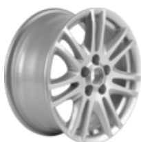
Könnyűfém keréktárcsa 16" 7 x 2 küllős kivitel, ezüst 7 x 16", ET 50, 205/55 R16 és 215/55 R16 gumiabroncsokhoz – Kivéve HEV
