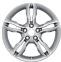
Könnyűfém keréktárcsa 17" 5 x 2 küllős kivitel, ragyogó nikkell 7 J x 17, ET 50 215/50 R17 gumibroncsokhoz – Kivéve EOnetic és HEV
