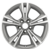
Könnyűfém keréktárcsa 16" 5x 2 küllős kivitel, arctic grey, polírozott 7 x 16", ET: 50, 205/55 R16 és 215/55 R16 gumiabroncsokhoz – Kivéve HEV
