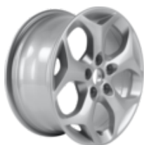
Könnyűfém keréktárcsa 16" 5 Y küllős kivitel, ezüst 7 x 16", ET 50, 205/55 R16 és 215/55 R16 gumiabroncsokhoz – Kivéve HEV
