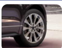
Könnyűfém keréktárcsa 20" 10 küllős kivitel, polírozott alumínium 8,5 x 20", ET 52,5, 255/45 R20 méretű gumibroncsokhoz – Vignale
