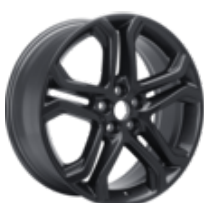
Könnyűfém keréktárcsa 19" 5 x 2 küllős Y-kivitel, prémium festett alumínium 8 x 19", ET 52,5, 235/55 R19 méretű gumibroncsokhoz. – Kivéve Vignale
