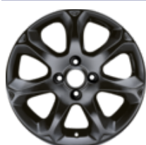
Könnyűfém keréktárcsa 16" 7 küllős kivitel, fekete (Panther Black) 6,5 x 16", ET 41,5, 195/45 R16 gumiabroncsokhoz
