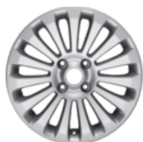
Könnyűfém keréktárcsa 16" 15 küllős kivitel, ezüst 6,5 x 16", ET 41,5, 195/45 R16 gumiabroncsokhoz
