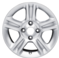
Könnyűfém keréktárcsa 15" 5 x 2 küllős kivitel, ezüst 6 x 15", ET 47,5, 195/50 R15 gumiabroncsokhoz
