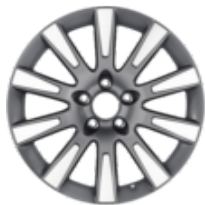
Könnnyűfém keréktárcsa 17" 10 küllős kivitel, ezüst polírozott 7 x 17", ET 50, 205/50 R17 gumiabroncsokhoz
