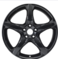
Könnyűfém keréktárcsa 18" 5 küllős kivitel, Absolute Black 8 x 18", ET 55, 235/40 R18 gumibroncsokhoz, csak kormányelfordulás-határolóval együtt – Kivéve EONetic és RS
