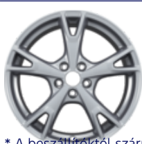
Könnyűfém keréktárcsa 18" 5 küllős Y kivitel, ezüst 8 x 18", ET 55, 235/40 R18 gumibroncsokhoz, csak kormányelfordulás határolóval szerelve – Kivéve EONetic és RS
