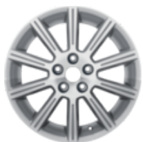
Könnyűfém keréktárcsa 17" 10 küllős kivitel, ezüst 7 x 17", ET 55, 225/50 R17 gumibroncsokhoz – csak kormányelfordulás határolóval szerelve, 2006 -tól
