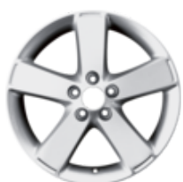
Könnyűfém keréktárcsa 17" 5 küllős kivitel, polírozott külső rész 7 x 17", ET 55, 225/50 R17 gumibroncsokhoz – csak kormányelfordulás határolóval szerelve, 2006 -tól
