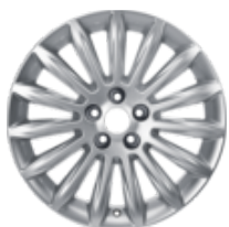
Könnyűfém keréktárcsa 17" 15 küllős kivitel, Ezüst 7 x 17", ET 55, 225/50 R17 gumibroncsokhoz – csak kormányelfordulás határolóval szerelve, 2006 -tól
