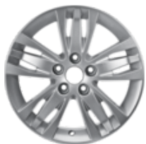
Könnyűfém keréktárcsa 16" 5 x 3 küllős kivitel, ezüst 6,5 x 16", ET 50, 215/60 R16 gumibroncsokhoz – 2006 -tól
