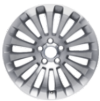
Könnyűfém keréktárcsa 17" 15 küllős kivitel, ezüst 7,5 x 17", ET 55, 235/45 R17 gumiabroncsokhoz, kivéve 1,6L benzinmotorok
