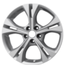
Könnyűfém keréktárcsa 17" 5 x 2 küllős kivitel, Sparkle Silver 7 x 17", ET 50, 215/50 R17 gumiabroncsokhoz, kivéve 1,6L benzinmotorok
