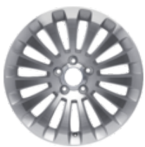
Könnyűfém keréktárcsa 17" 15 küllős kivitel, ezüst polírozott 7,5 x 17", ET 55, 235/45 R17 gumiabroncsokhoz, kivéve 1,6L benzinmotorok
