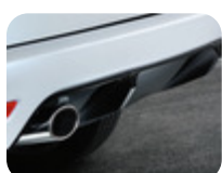
Hátsó lökhárító alsó rész Beépített diffúzorral, alapozott, fényezendő – tolatóradarral felszerelt dupla kipufogócsöves gépkocsikhoz, 03/2010 től
