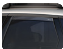
ClimAir®* Ajtó szélterelő hátsó ajtóüvegekhez, átlátszó 2 darabos készlet, a jobb szellőzés érdekében, véd a hó és az eső ellen, 3 mm-es öntött akril üveg. Győződjön meg arról, hogy a légterelő (a tükörnél lévő részen) az ablakperemen ül (sínen) és nem csúszik be az ablak nyílásába. ABE-vel TÜV-re tesztelve. – Kombihoz
