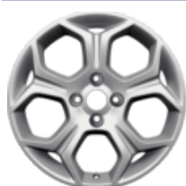
Cerchi in lega 17" a 5 razze a Y, Silver 6,5 x 17", disassamento 40, per pneumatici 205/45 R17 – sono in abbinamento con limitatore di sterzata
