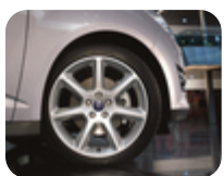
Cerchi in lega 18" a 7 razze, argento 8 x 18", offset 55 mm, per pneumatici 235/40 R18 – solo in abbinamento con limitatori di sterzata
