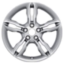
Cerchi in lega 17" a 5 x 2 razze, nichel lucido 7 J x 17, offset 50, per pneumatici 215/50 R17
