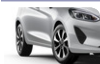
Cerchi in lega 16" a 8 razze, Rock Metallic lavorato 6,5 x 16", offset 47,5 per pneumatici 195/55 R16
