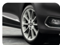
Cerchi in lega 17" a 10 razze, Luster Nickel 7 x 17", offset 47,5 per pneumatici 205/45 R17
