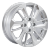
Cerchi in lega 16" a 6 x 2 razze, Sparkle Silver 6,5 x 16", offset 47,5, per pneumatici 195/55R16 – Titanium
