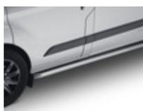
**ARP\* Barra di protezione laterale In acciaio inox lucido, design tubolare con angoli incurvati**
