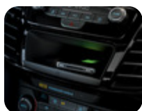
ACV Kit di ricarica wireless Qi soluzione integrata specifica per il veicolo
