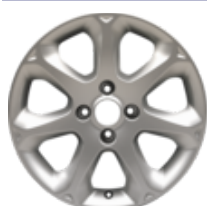
Lichtmetalen velg 16" 7-spaaks design, zilver 6,5x16" velgen, ET 41,5, voor bandenmaat 195/45 R16
