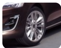
Lichtmetalen velg 18" 5 x 3-spaaks design, Silver Premium 8 x 18", ET 55, voor bandenmaat 235/40 R18 91V, alleen voor auto's uitgerust met 18" wielen af fabriek (stuuruitslagbegrenzer standaard gemonteerd). – Behalve Active
