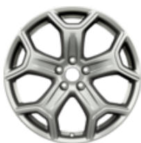
Lichtmetalen velg 19" 5-spaaks design, metallic afwerking 8 x 19", ET 52,5 voor bandenmaat 235/45 R19
