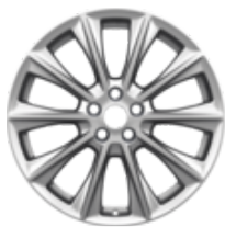
Lichtmetalen velg 18" 10-spaks design, metallic afwerking 7,5 x 18", ET 52,5, voor bandenmaat 235/50 R18
