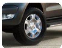
Lichtmetalen velg 17" 6-spaaks design, sprankelend zilver 8 x 17", ET 55, voor bandenmaat 265/65 R17 – vanaf 09/2015 onwards
