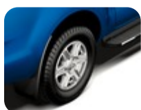
Lichtmetalen velg 17" 6-spaaks design, zilver 8.0 x 17", voor banden 265/65 R17. Standaard op Limited – tot en met 08/2015
