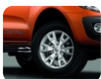
Lichtmetalen velg 18" 6-spaaks Y-design, zilver 8,0x18" velgen, voor bandenmaat 265/60 R18 – tot en met 08/2015
