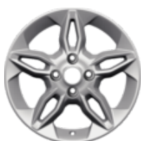
Alufelg 16" 5 x 2-eikers design, sølv 6,5 x 16", innpress 40, for dekk 195/55R16
