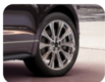
Alufelg 20" 10-eikers design, polert 8,5 x 20", innpress 52,5, for dekk 255/45 R20 – Vignale
