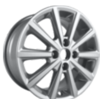
Alufelg 16" 10-eikers design, Sparkle Silver 6,5 x 16", innpress 47,5, for dekk 195/45 R16 og 195/50 R16
