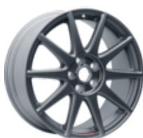
Performance felg 18" lett aluminiumsfelg med Ford Performance logo, 10-eikers design, Magnetite Matt 8 x 18", innpress 55, for dekk 235/40 R18, kun i kombinasjon med rattutslagsbegrenser – Unntatt Active
