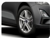
Alufelg 16" 5-eikers design, Sparkle Silver 6,5 x 16", innpress 50, for dekk 205/60 R16 – Unntatt Active og ST
