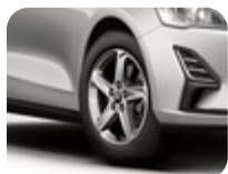
Alufelg 16" 5-eikers "Enkel-å-holde-ren"-design, Dark Sparkle 6,5 x 16", innpress 50, for dekk 205/60 R16 – Unntatt Active og ST
