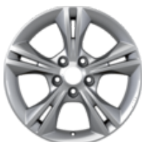
Obręcz aluminiowa 16" wzór 5 x 2-ramienny, srebrna 7 x 16", odsadzenie 50, do opon 205/55 R16 i 215/55 R16, do modeli EOnetic możliwość montażu tylko opon 205/55 R16 – Nie do modeli HEV.
