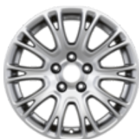
Obręcz aluminiowa 16" wzór 10 x 2-ramienny, srebrna 7 x 16", odsadzenie 50, do opon 205/55 R16 i 215/55 R16. Modele EOnetic tylko z oponami 205/55 R16 – Z wyjątkiem modeli HEV.
