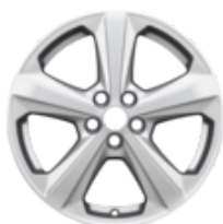
Obręcz aluminiowa 18" Wzór 5-ramienny, sparkle silver 7,5 x 18", odsadzenie 55, do opon 235/50 R18.
