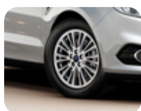
Obręcz aluminiowa 17" Wzór V 10-ramienny, sparkle silver 7,5 x 17", odsadzenie 55, do opon 235/55 R17.
